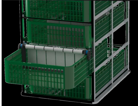
Figuur 67: Prototype 2 - een balk met flappen wordt op de lade van de containers gezet. De kippen worden door de flappen in de lade geplaatst.
