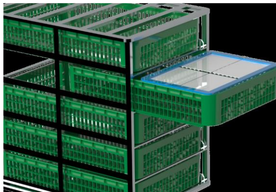
Figuur 66: Prototype 1 – een kader wordt op de lade van de container geplaatst. De kippen worden door de flappen in de lade gezet.
