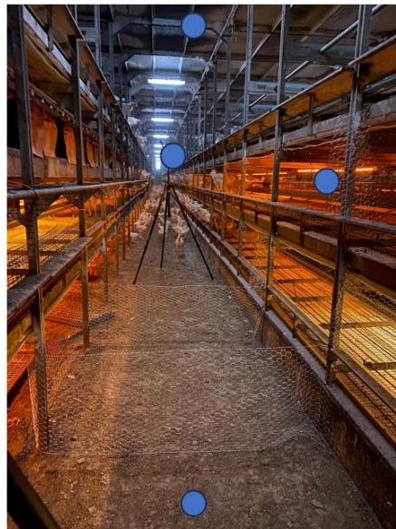
Figuur 8: Opstelling camera's met één aan het plafond voor het bovenaanzicht, twee op statieven om het zijaanzicht in kaart te brengen en één in het volièresysteem voor het vooraanzicht. Er werd kippengaas gebruikt om een zone af te bakenen zodat de kippen niet ontsnapten.
